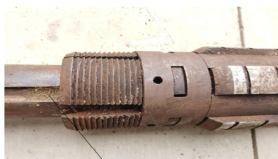
图 2 封隔器轨道积砂图
