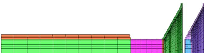
图 2 隔膜行程分析有限元模型
