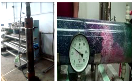
图5 单位长度滑移压力
