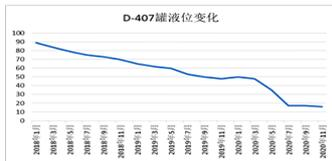
图2 D-407罐液位变化趋势图 (单位: %)
