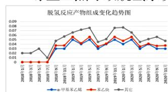
图6 脱氢反应产物组成变化趋势图 (单位: ppm)
