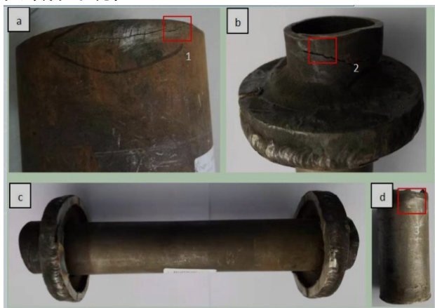
图 1 失效无缝钢管裂纹的宏观形貌
