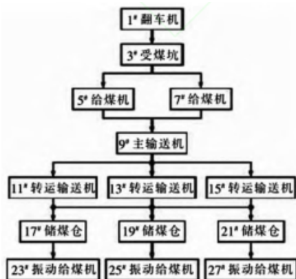
图 1 原煤系统工艺流程
