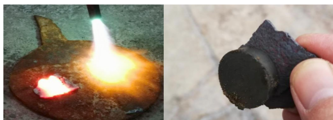
图5 剥落氧化皮的灼烧及磁铁吸附情况
