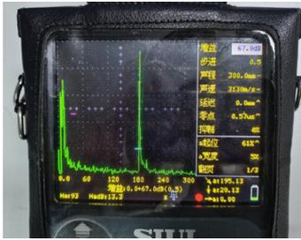
图3 检测试块上表面反射信号
