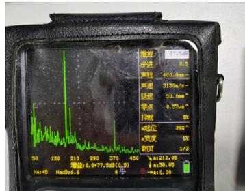
图5 厚度18mm试块检测波形图
