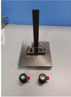
图2 导波杆与被检测试块连接装置
