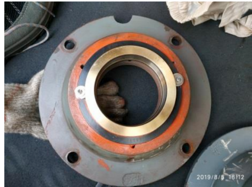
图 5 在静环上安装压块
