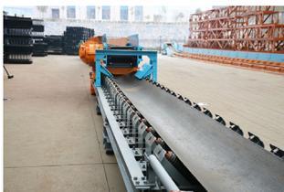
图1 皮带输送机
