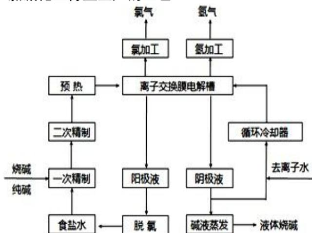
氯碱化工是众多化工生产的基础之一，广泛应用于化学工业、纺织工业以及冶金行业、造纸行业等。氯碱化工生产过程中，需要电解食盐水（固定质量比例为1:0.85），食盐溶解后经直流电解制取烧碱、氯气以及氢气，然后利用于其他生产工作。目前我国氯碱化工生产主要采用离子交换膜电解生产方式。离子交换膜法主要是在电解槽阳极和阴极电极之间安装由氟树脂制成的带有功能基团的离子交换膜。在泵的输送（强制循环）或位差的作用下（自然循环），精盐水和稀释碱液会稳定流经离子膜的阴阳极两侧。电流穿过离子膜后，阳极会产生氯气，阴极则产生烧碱和氢气。
