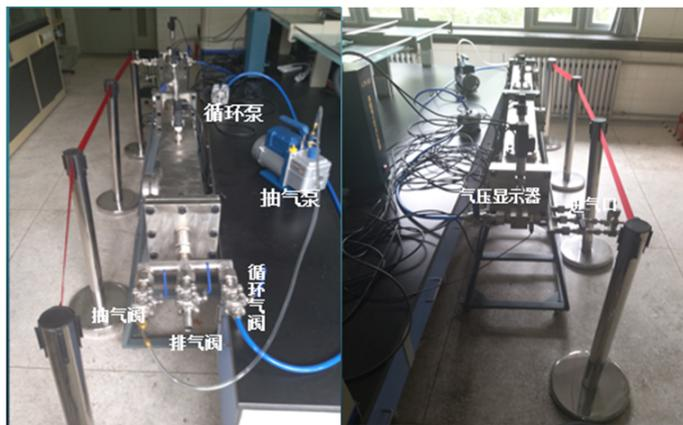
图 1 丁烷-空气混合气体爆炸实验装置
