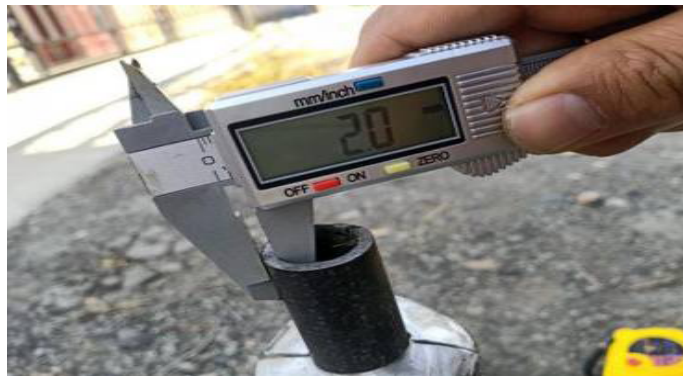
图 2 管壁厚度现场实测
