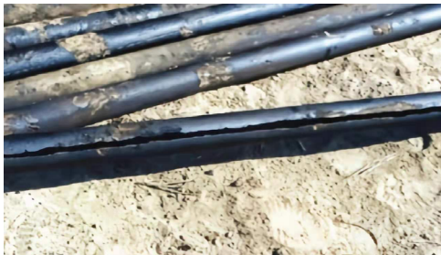
图 2 油管本体被磨漏
