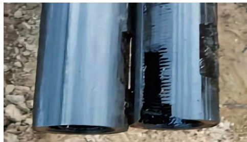
图 1 抽油杆接箍磨损严重
