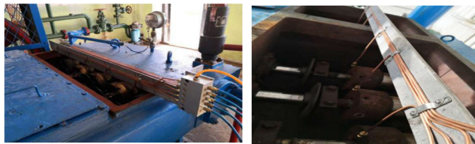
图4 自动油气润滑系统的现场应用
