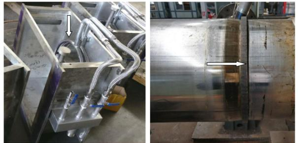
图3 设计双喷淋环加强外冷、一体式的过渡套结构
