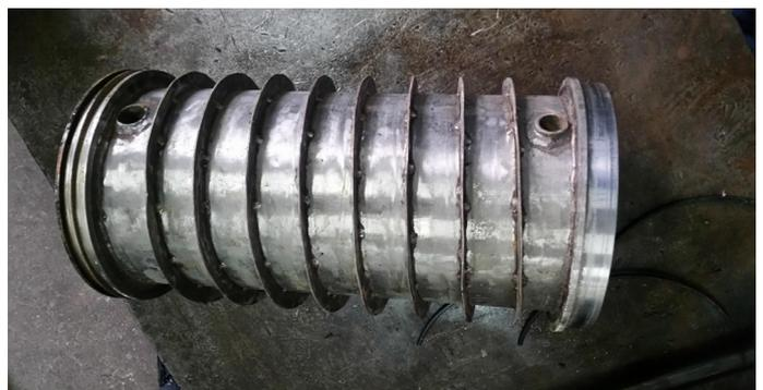
图5 新冷却结构螺旋水套
