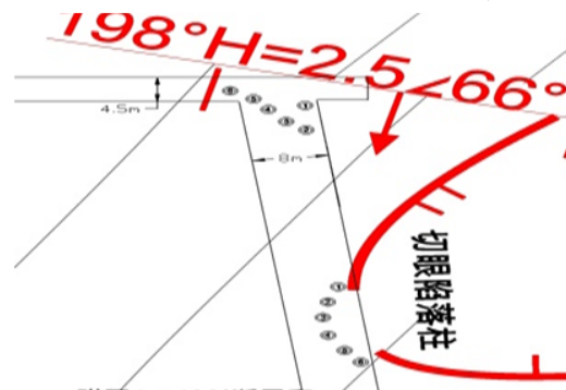
图 2 切眼施工注浆钻孔图
