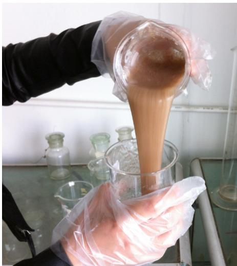
①药剂无需在配制站或配制池配制, 将配制、携砂一体化。在满足压裂液稳定携带支撑剂能力下, 可有效的简化工序, 提高液体质量、减少监控所需的条件、降低成本、提高压裂效率;
