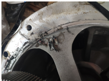
图11 滚动轴承的保持架断裂脱落
