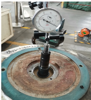
图3 输出轴窜量测量
