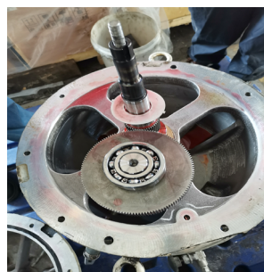
图7 解体增速箱检查轴承
