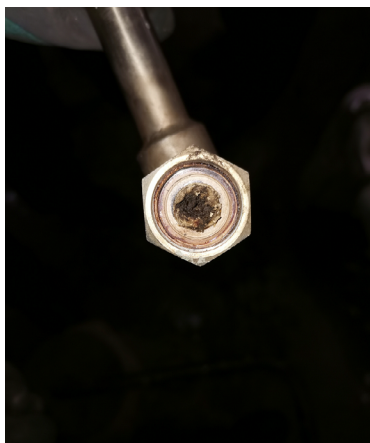
图6 旋液分离器回流口堵塞
