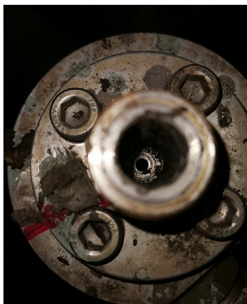
图7 旋液分离器内部聚合物积聚
