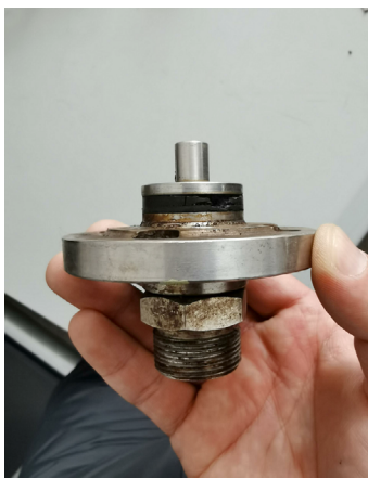
图8 旋液分离器密封圈损坏
