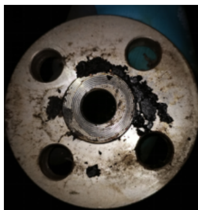
图 4 悬液分离器接口堵塞
