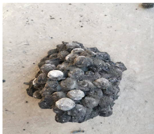
图 3 脱氯剂结块示意图
