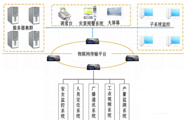
图2 矿井监控系统拓扑结构
