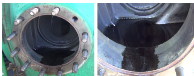
图 3 缸体内积液严重
