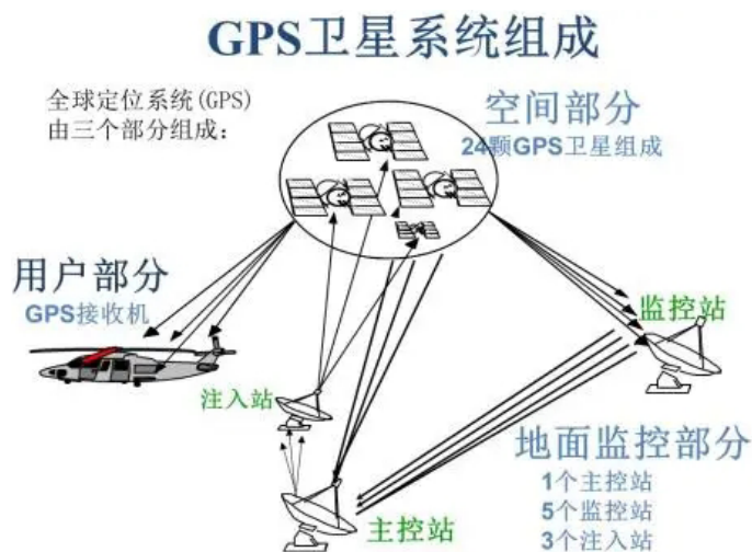
图 1 GPS 系统的基本原理
