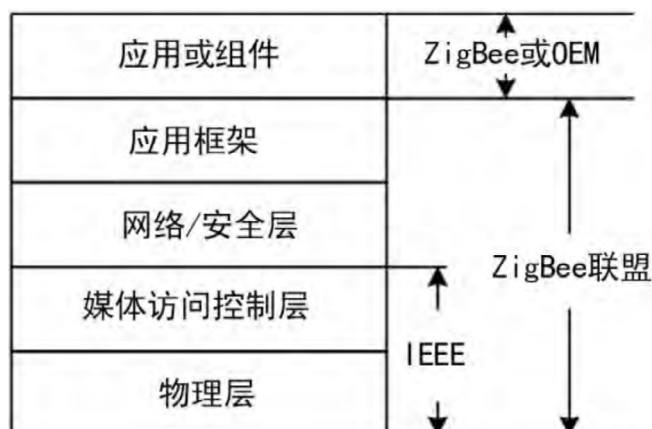
图 2 ZigBee 技术协议组成
