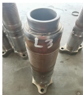
图 7 衬套密封面的气蚀坑
