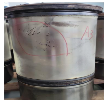
图 4 缸套表面的气蚀孔
