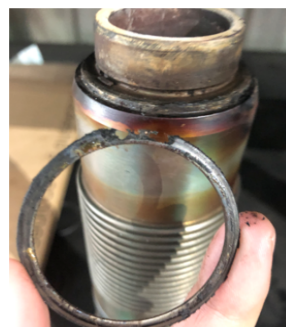
图 8 气蚀损坏的密封垫片
