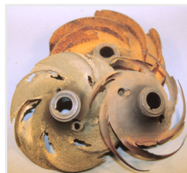
图 2 气蚀失效的水泵叶轮
