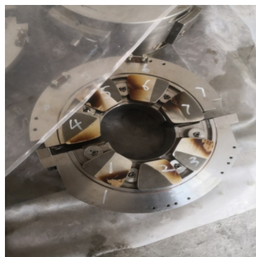
图 4 被磨损的主推力轴承
