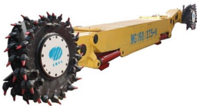
图2 电力牵引采煤机
