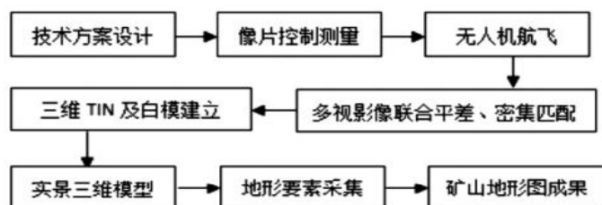
图3 无人机测量数据处理建模流程
