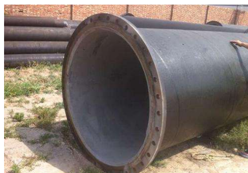
图1 内衬水泥砂浆油气管道
