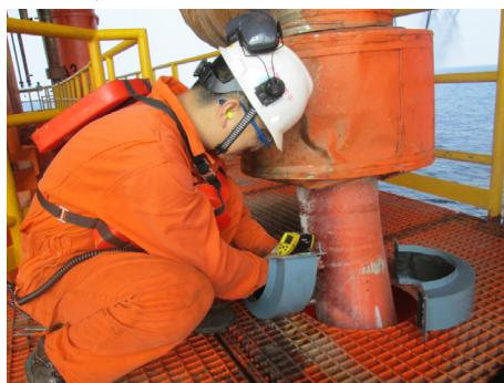
图6 现场人员测试贴片式温度变送器测量效果
