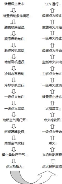
图 2 浸没燃烧式气化器启机顺控
