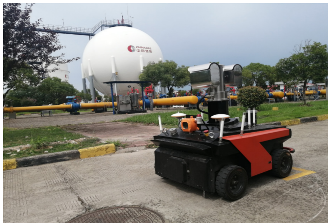
图2 燃气防爆智能巡检机器人“U7 卫士”
