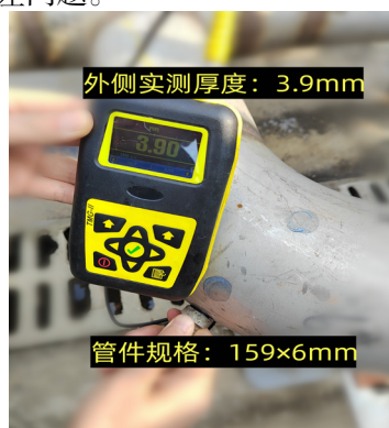
图1 弯头壁厚偏薄严重
