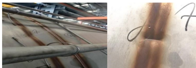
图4 加强圈撕裂后导致筒体局部变形示例
