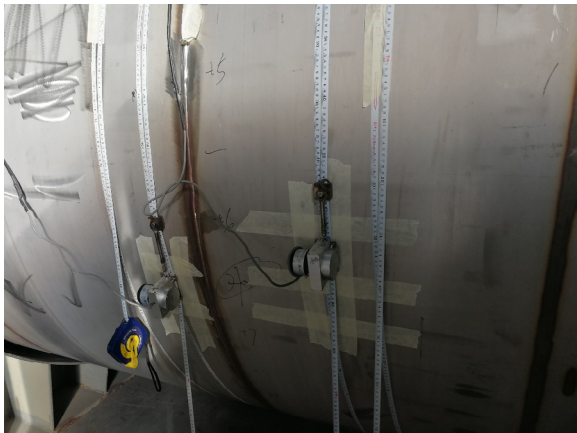
图 2 采用位移传感器和卷尺测量变形
