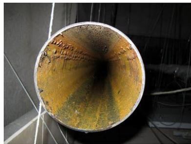
图1 石油管道腐蚀
