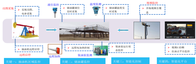
图2 拉油点数智化配套建设技术框架
