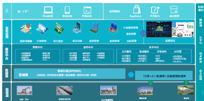
图1 油气生产能源管控系统总体架构图
