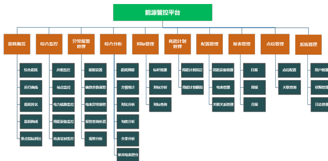
图2 油气生产能源管控系统功能架构图
