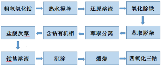
图2 粗氢氧化钴加工流程图
