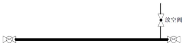
图 1 阀室放空简化模型示意图
