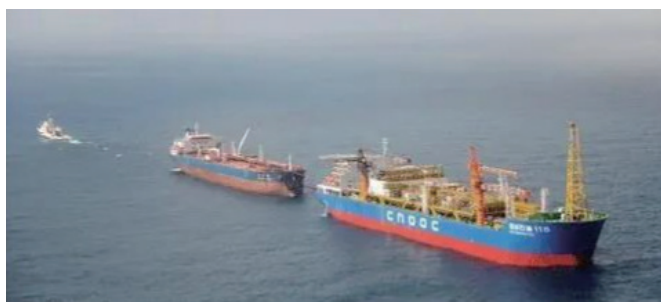
图 1 FPSO 进行外输作业
